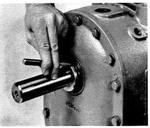
FIGURE 11 BENDING TANG OF SPIDER WASHER OUT OF LOCK NUT SLOT
