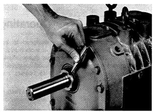
FIGURE 35 BENDING SPIDER WASHER TANG INTO LOCK NUT SLOT
