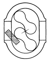
FIGURE 28 ROTOR AND SPACER BLOCK POSITION FOR INDEXING GEARS (AS VIEWED FROM GEAR END)
